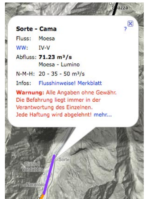
Beispiel für ein Info-Fenster zu einem Flussabschnitt (hier: Sorte-Cama) mit Angabe des momentanen Abflusses an der Messstelle Lumino sowie Niedrig-, Mittel- und Hochwassermengen.
